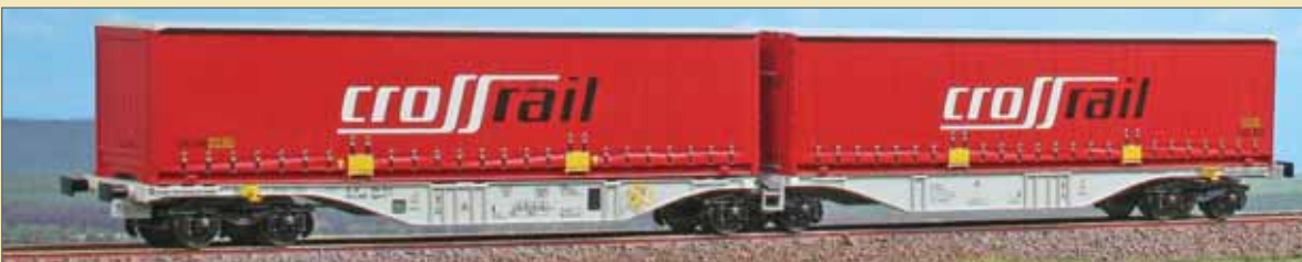
Carro intermodale Tipo Sggmrss '90 bimodulo "Crossrail" con carico di casse mobili. Container wagon Type Sggmrss '90 "Crossrail" with swap bodies. Containerwagen Typ Sggmrss '90 Doppelmodul "Crossrail" mit Wechselpritschen.
